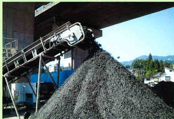
高含水比の泥水を数分で粒状固化し、コンベアーでの搬送がスムーズに。
