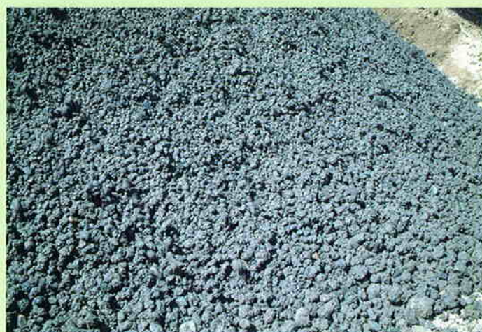
含水比250%以上の泥水の粒状固化物
