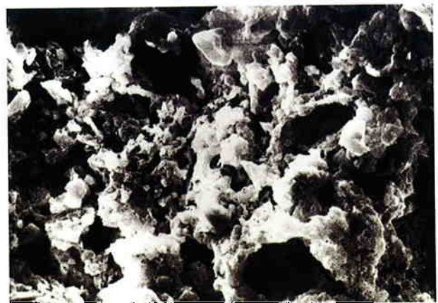
ナルファルトC混入コンクリート破断面(1000倍拡大)
