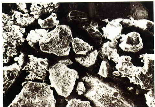
プレーンコンクリート破断面(1000倍拡大)
