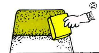
サビトール1、水を1～2の割合で希釈した液をスポンジ、又はスプレーで塗布します。希釈にはポリバケツを使って下さい。
