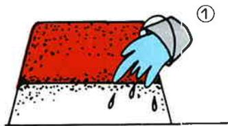
サビの付着したコンクリート面をたっぷり水でしめらせます。コンクリート面に油膜があれば工業セッケンで洗い流して下さい。
