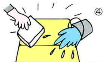
サビが取れたらすぐコンクリート面を良く水で洗って下さい。これで作業は完了です。水洗いはコンクリート面が乾燥しない前に行ってください。
