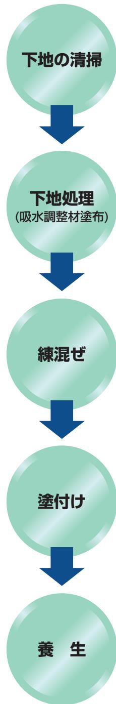
住宅基礎コンクリートの幅木部分を点検し、型枠ジョント部の段差、バリ等による突起物をはりとり、また、埃、ぜい弱層・レイターン・油分・汚れ等をワイヤブラシ・サンダー掛け等で除去し、水洗い清掃または高圧洗浄等をおこなってください。
