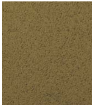
吹付け リシン仕上げ (264) 吹付け リシンガン 寒水石配合 PCH PCDH
