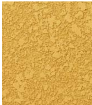
吹付け スタッコヘッドカット仕上げ (365) 吹付け + コテ (下吹き)リシンガン (上吹き)スタッコガン+機 寒水石配合 PCH PCDH
