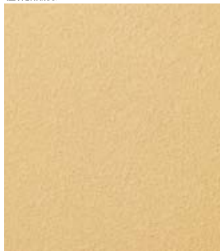
吹付け 梨子地仕上げ (257) 吹付け リシンガン PCH PCDH
