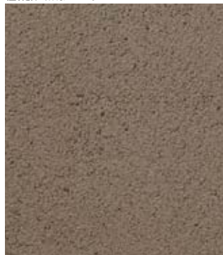
吹付け ブリック仕上げ (403) コテ + 吹付け リシンガン 寒水石配合 PCH PCDH
