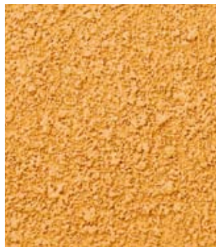
吹付け スタッコ仕上げ (362) 吹付け (下吹き)リシンガン (上吹き)スタッコガン 寒水石配合 PCH PCDH
