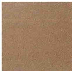
吹付け 梨子地仕上げ (104)
