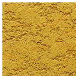
吹付けトラバーチン仕上げ (369)
