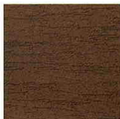
吹付け荒壁仕上げ (251)
