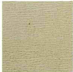
パイプローラー 横仕上げ (160)
