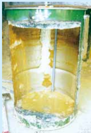
コロイドセメント注入固結体
