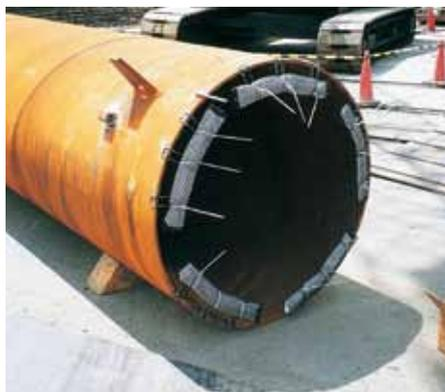
▲鋼管杭(鋼管杭専用金具使用)
