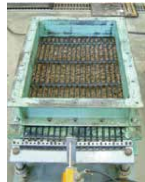
写真-2 土中引抜き試験機
