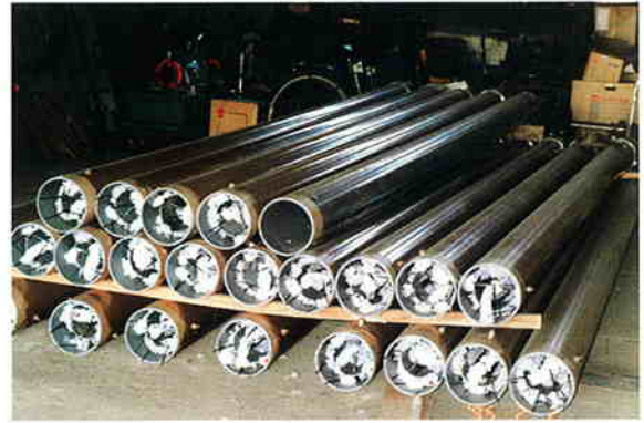
公園池浄化 パイプ内バイオコード設置状況
