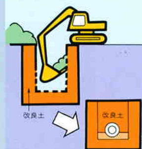
▲管・人孔基礎の改良
