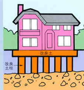
▲建築基礎の改良
