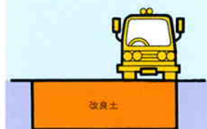
▲仮設道路の改良
