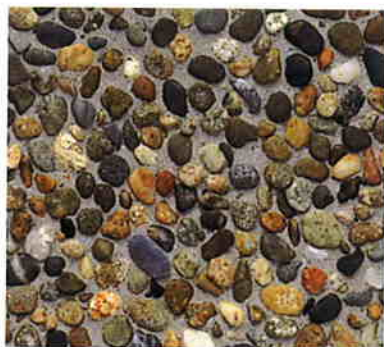
見本：洗い出し工法仕上げ
