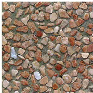
見本：洗い出し工法仕上げ
