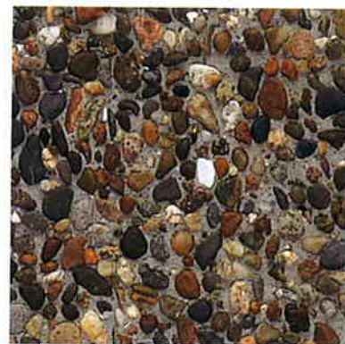
見本：洗い出し工法仕上げ
