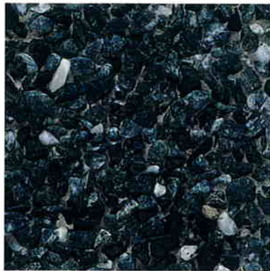
見本：洗い出し工法仕上げ
